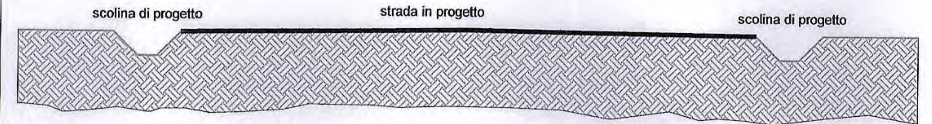
SEZIONE TIPO N. 1 - SCOLINE DI PROGETTO - scala 1:100 (da verificare in sede di progettazione esecutiva)
