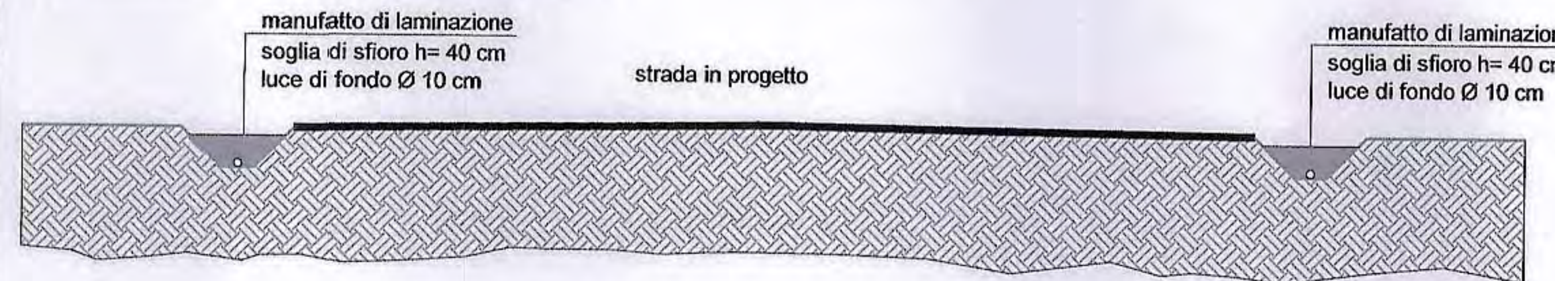
SEZIONE TIPO N. 2 - MANUFATTI REGOLATORI DI PORTATA - scala 1:100 (da verificare in sede di progettazione esecutiva)
