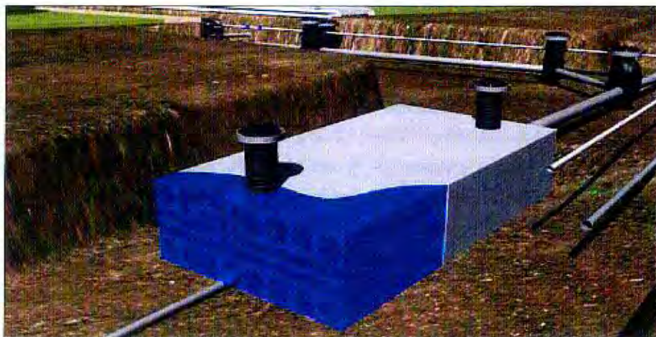
Assemblaggio tipo di celle interrante in polipropilene
