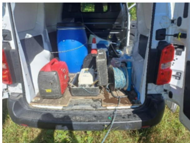
Strumentazione utilizzata per il prelievo delle acque sotterranee dai piezometri – a dx: pompa elettro-sommersa
