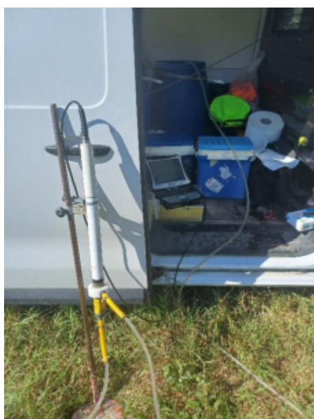
Particolare della sonda multi-parametrica e della cella di flusso per la registrazione dei parametri chimico-fisici
