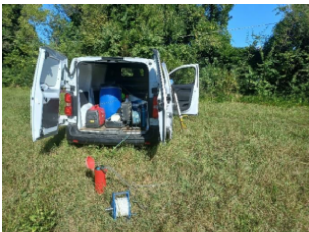
Fase di spurgo del piezometro pre-campionamento delle acque sotterranee
