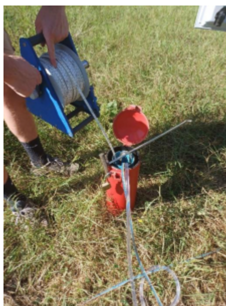
Misura del livello dinamico della falda durante la fase di spurgo pre-campionamento
