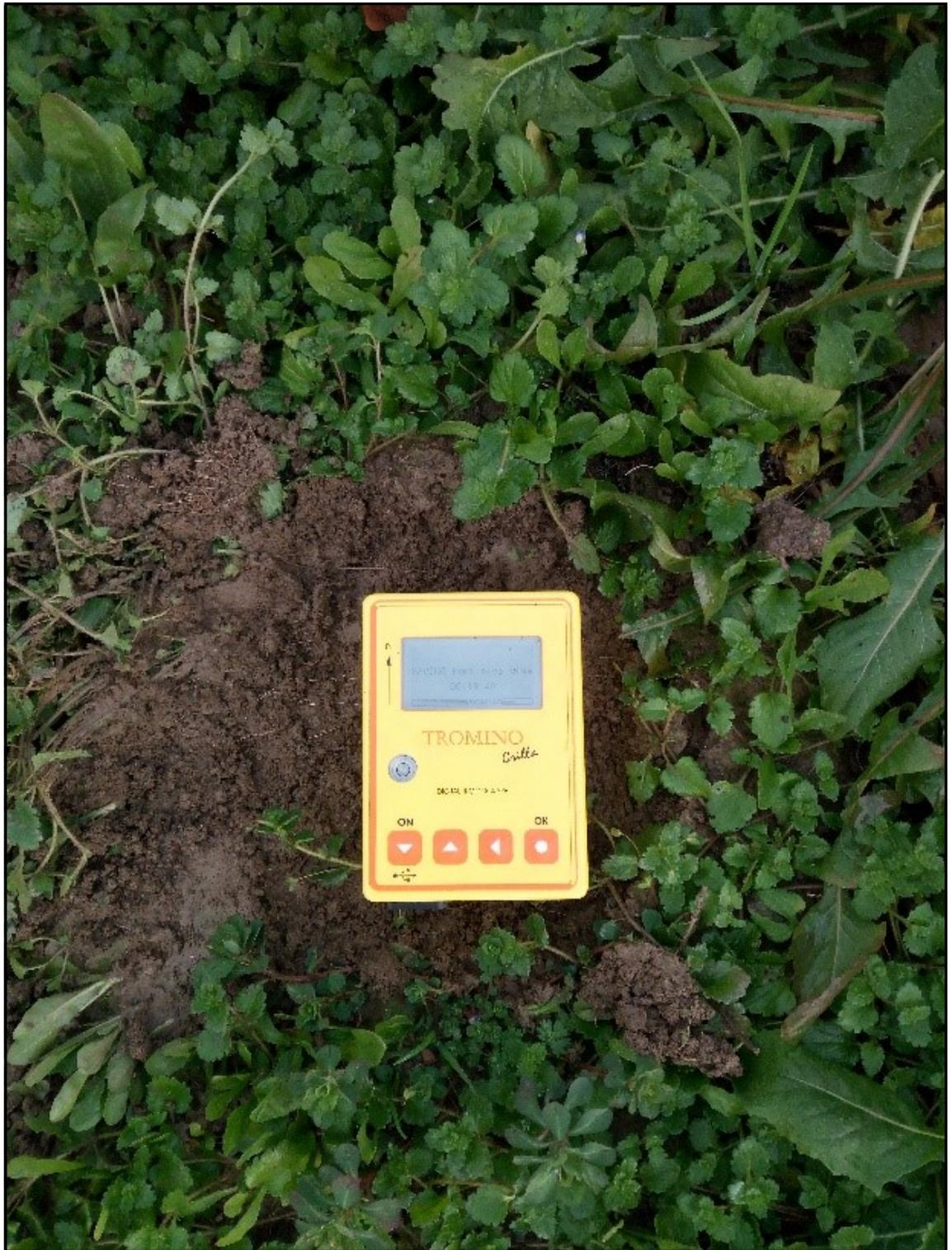
**Sismografo triassiale in dotazione con sensori ortogonali da 4,5 Hz e convertitore A/D 24 bit**
