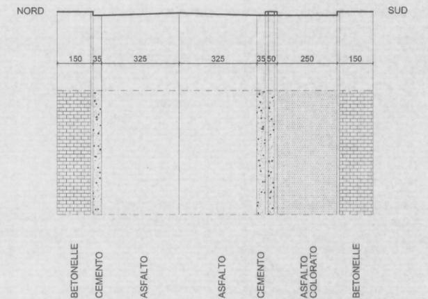
PIANTA E SEZIONE A-A VIA DON LORA scala 1 : 100
