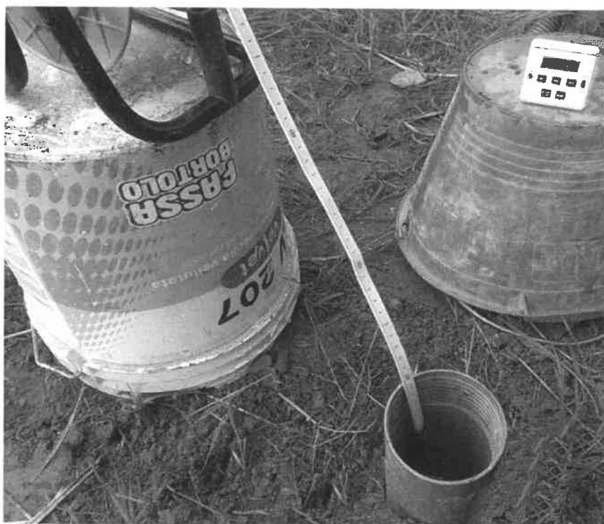
Foto 2: Piezometro installato e monitoraggio profondità Falda
