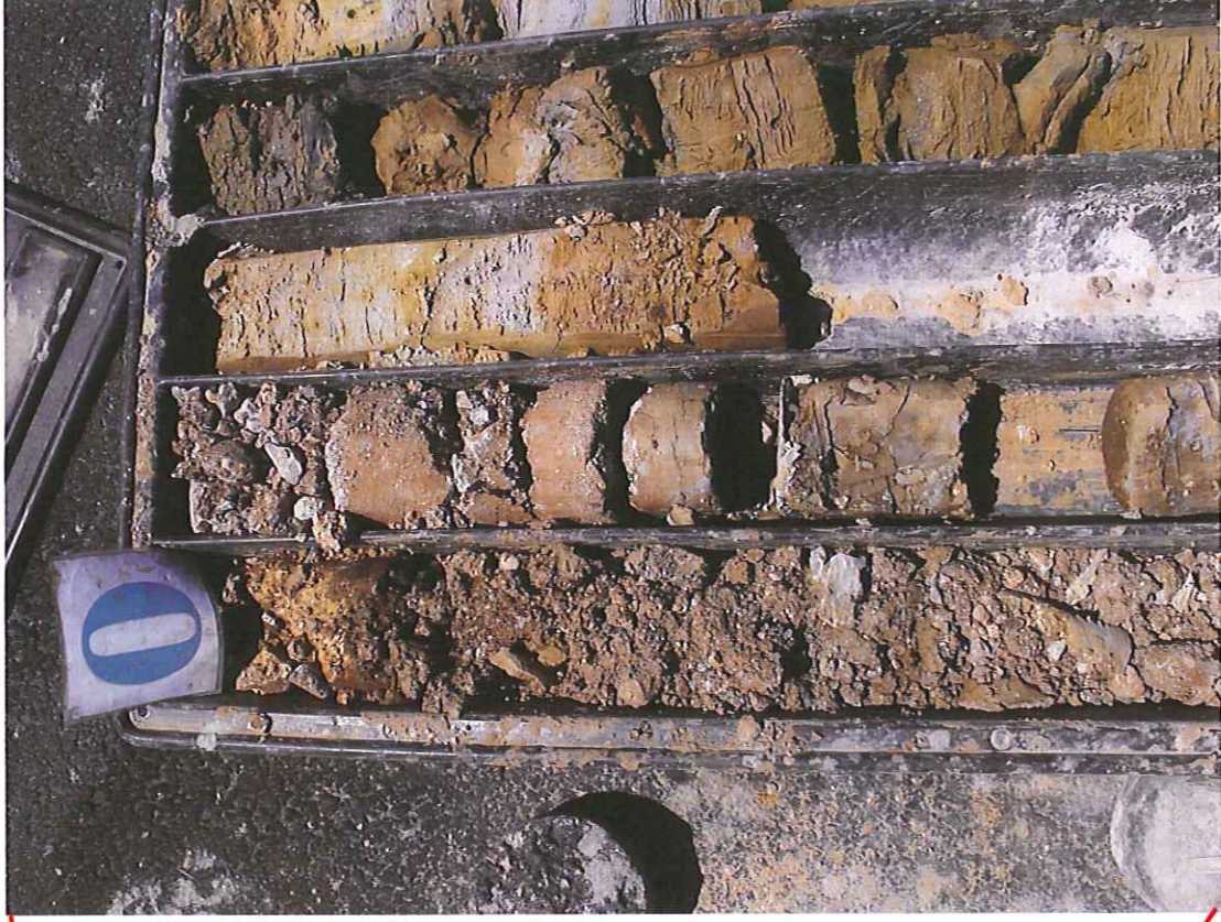
Foto 21: Ghiaie superficiali e limi argillosi
