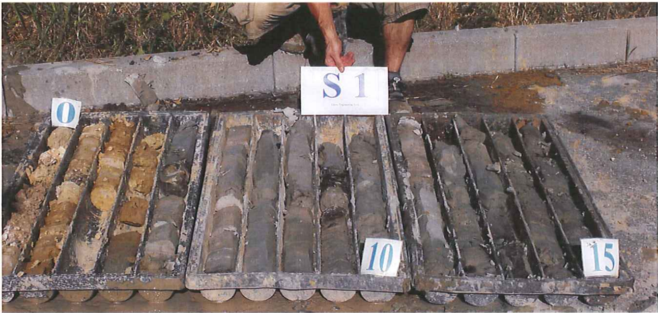
Figura 5 – Sondaggio S1 da 0.00 m a – 15.00 m da p.c.
