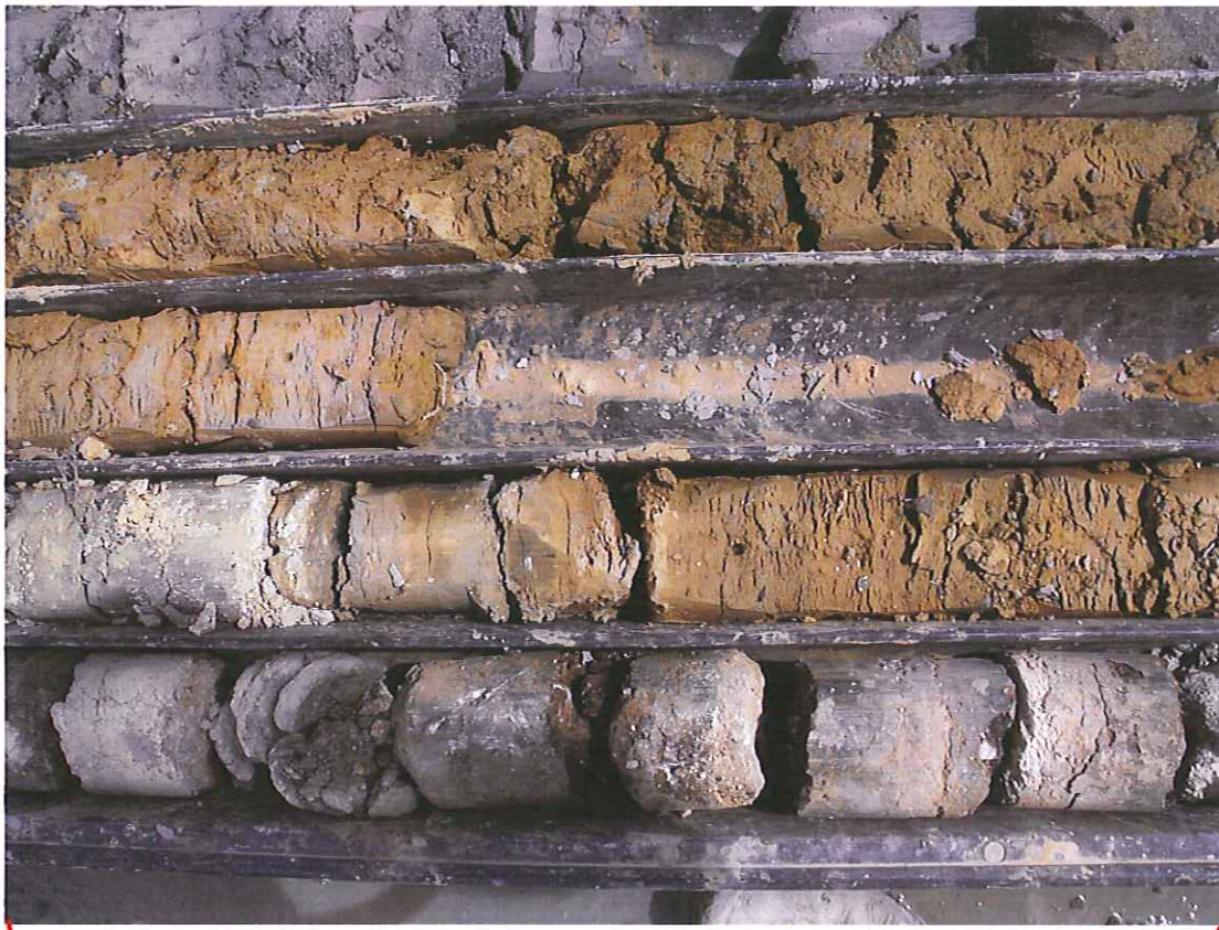
Foto 14: Particolare passaggio dalle ghiaie ai limi argillosi
