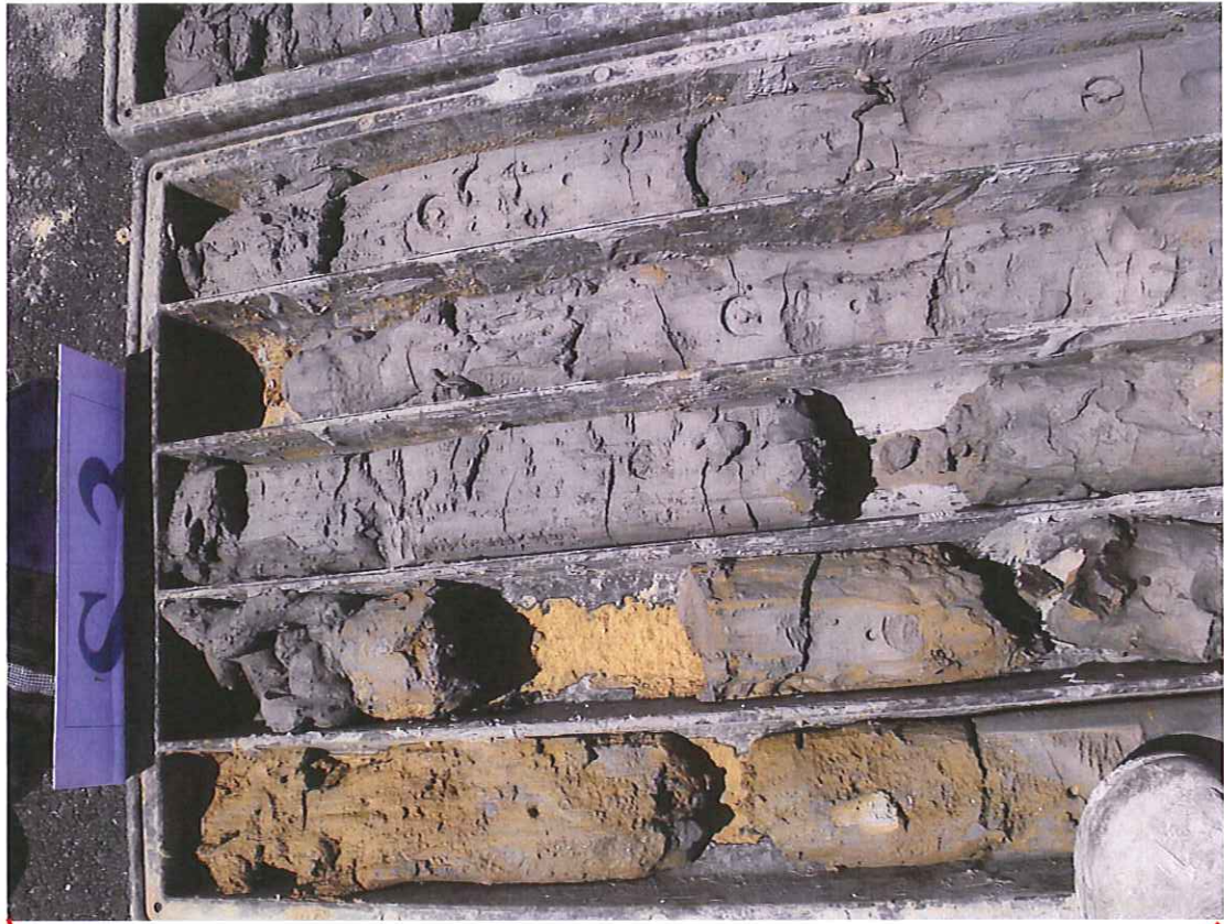
Foto 23: Particolare passaggilimi sabbioso argillosi a limi sabbiosi
