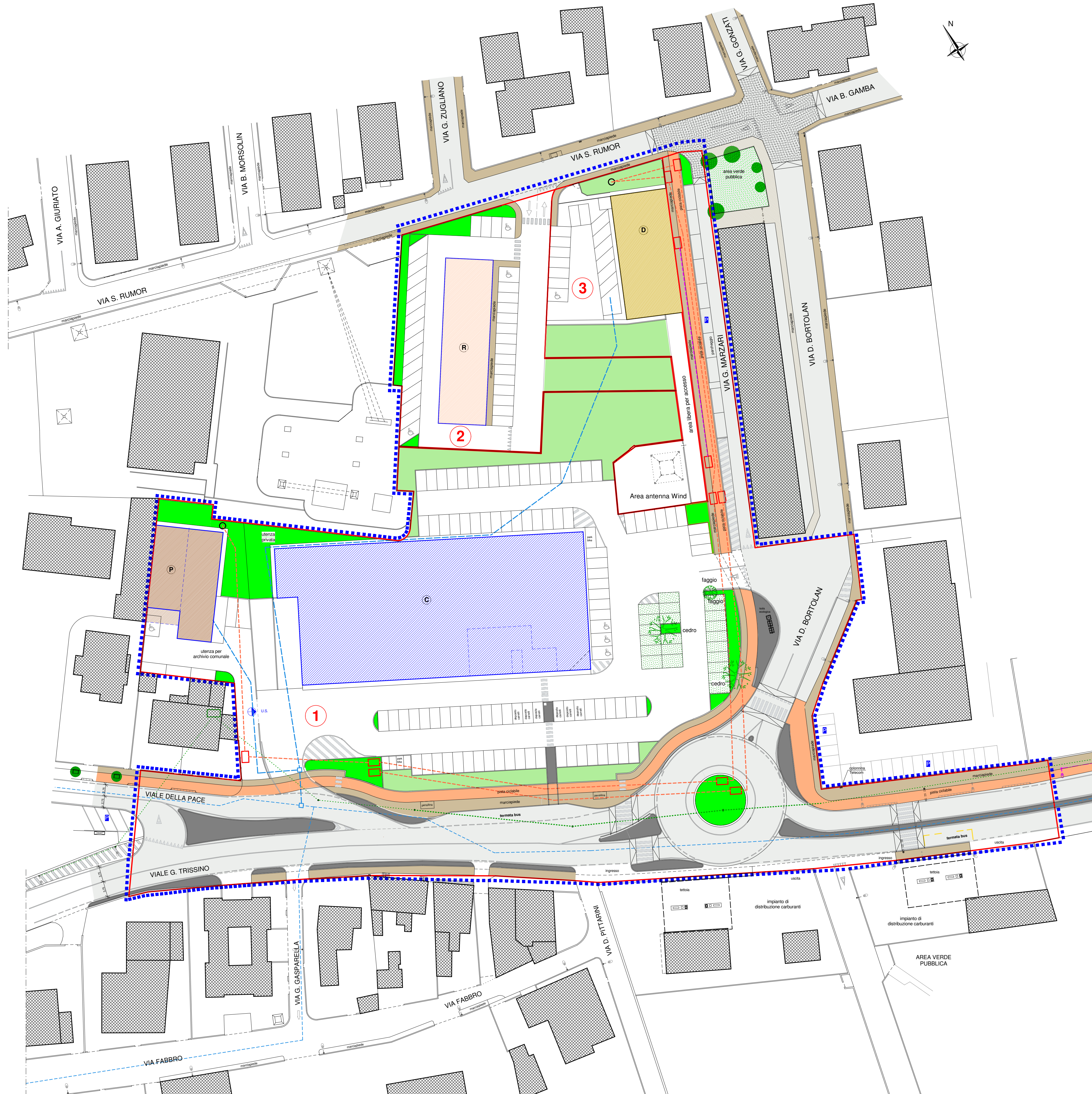
PLANIMETRIA GENERALE 1:500 - telecomunicazioni e telecontrollo
