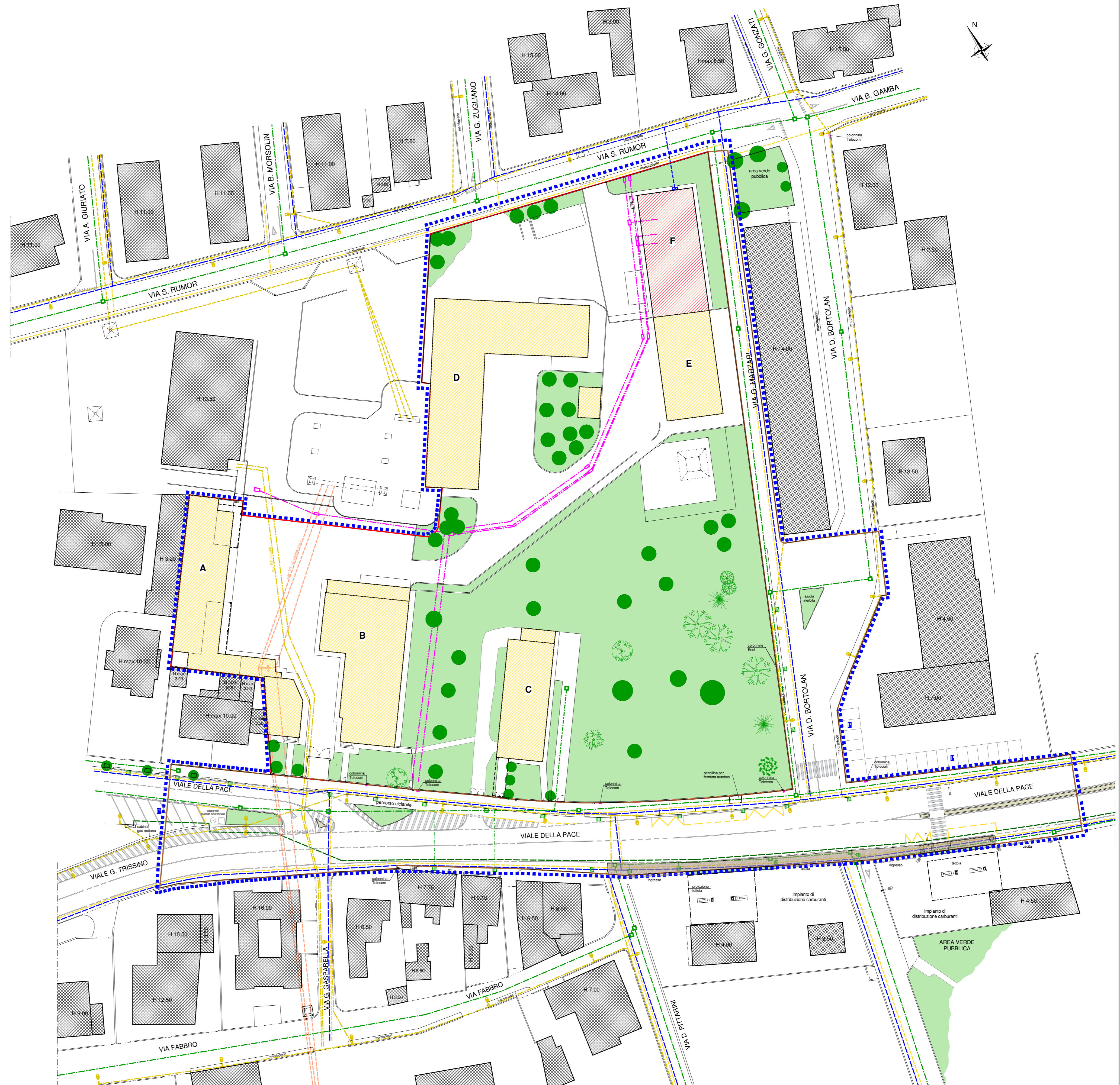
PLANIMETRIA GENERALE 1:500 - reti tecnologiche e demolizioni
