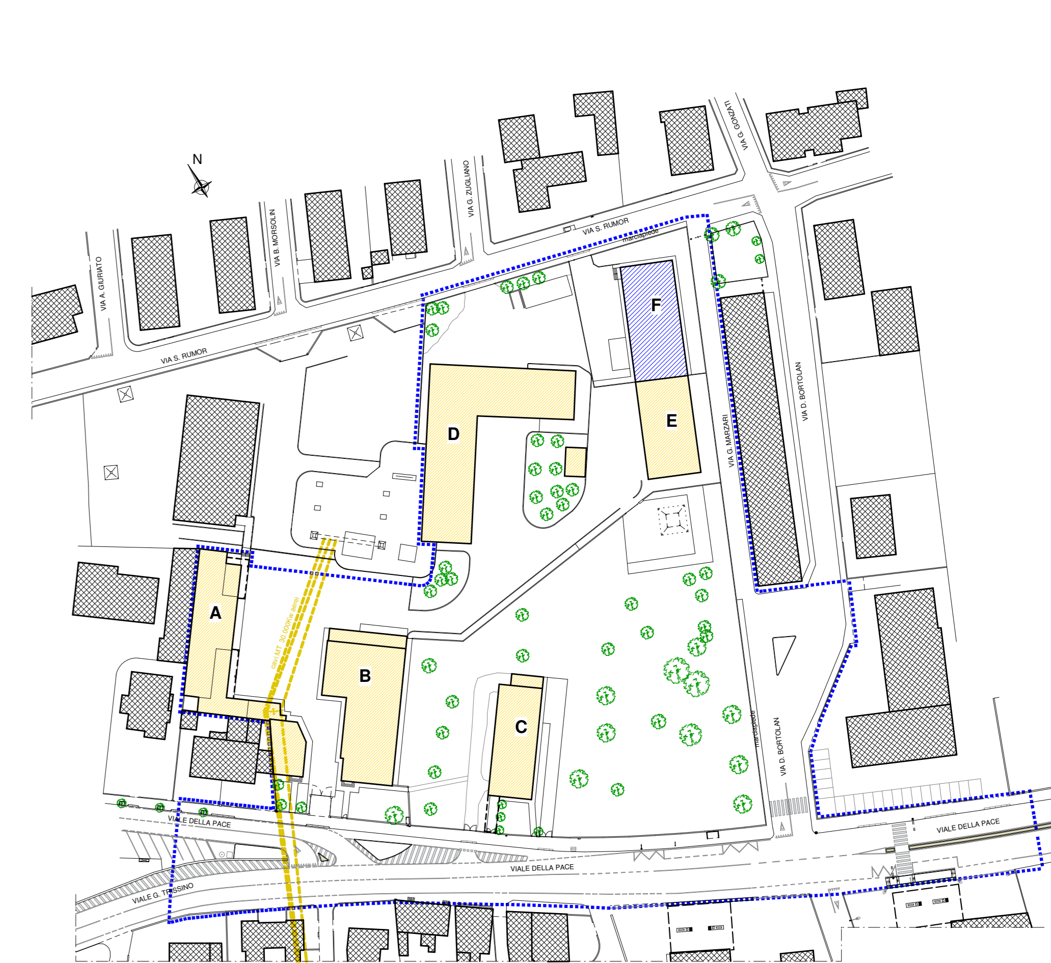
PLANIMETRIA GENERALE 1:1000 - rete energia elettrica stato attuale
