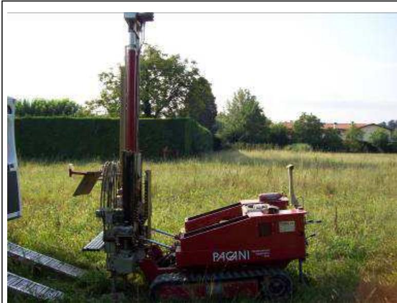
Foto 1: Esecuzione prova CPT1
