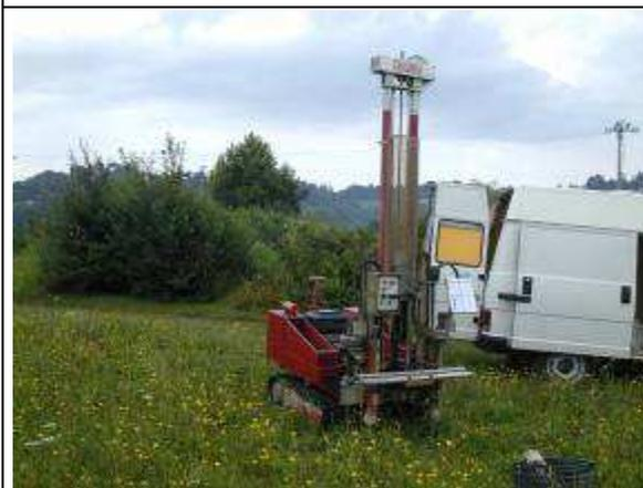
Foto 5: Esecuzione prova CPT4
