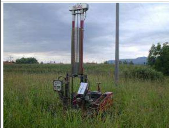
Foto 3: Esecuzione prova CPT2
