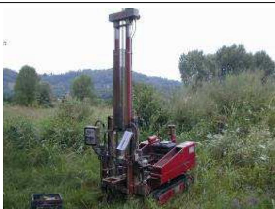
Foto 2: Esecuzione prova CPT1
