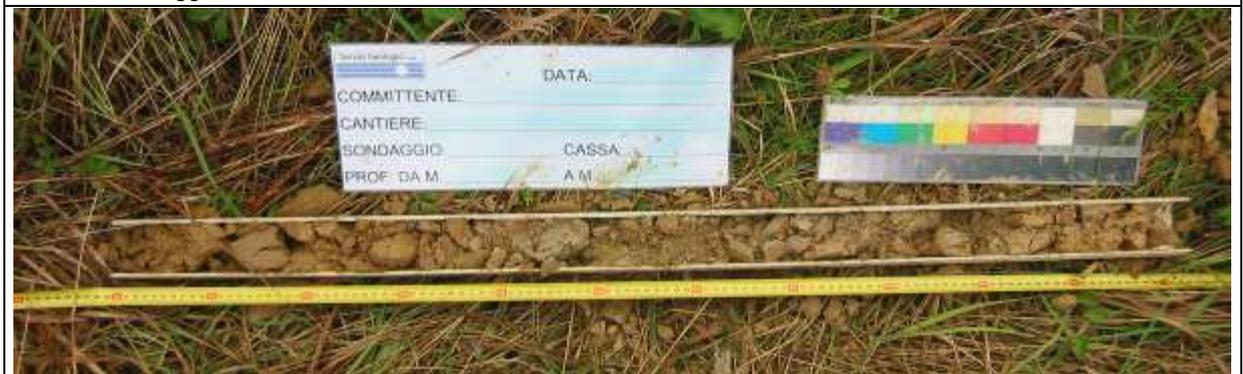
Foto 11: sondaggio T2 da 1.10 a 2.20 m
