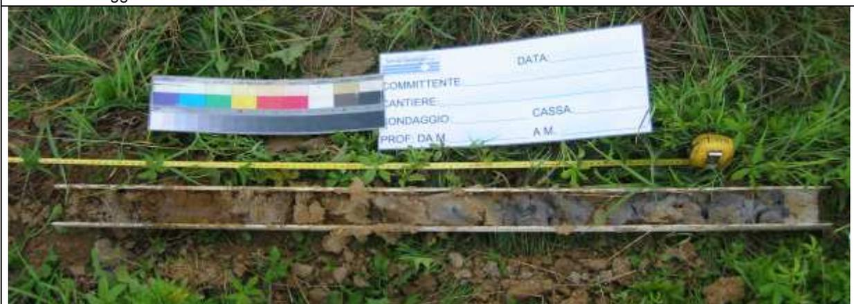
Foto 9: sondaggio T1 da 2.20 a 3.30 m
