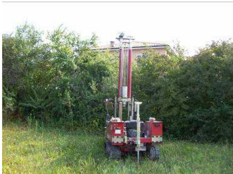
Foto 2: Esecuzione prova CPT2
