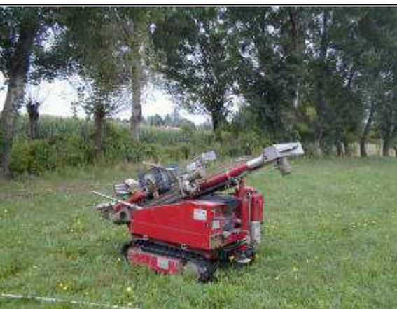
Foto 6: Esecuzione prova CPT5
