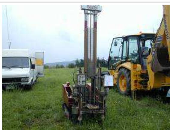
Foto 4: Esecuzione prova CPT3
